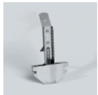
Kombihänger für CD 60/27 abgehängt durch Draht mit Öse oder mit Noniusystem. Sicherer Sitz im Profil durch Doppelclip, Tragfähigkeit in Abhängigkeit zur Anwendung
