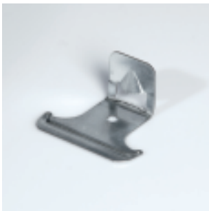
Ankerwinkel für CD 60/27 zur Verbindung von CD-Profilen über Kreuz im 90°-Winkel
