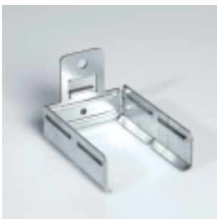
Universalverbinder für CD 60/27 zur Verbindung von niveaugleichen Profilverbindungen in flexiblen Winkel- einstellungen, als CD Längsverbinder oder als Abhängerkomponente
